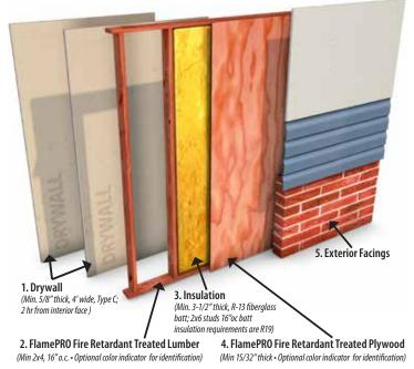
**1 & 2 HOUR TESTED EXTERIOR WALL ASSEMBLIES**
